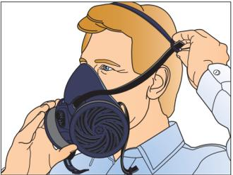
Ajuste el tamaño del arnés para la cabeza de modo que se apoye cómodamente en la corona según sea necesario. Coloque el respirador debajo de la barbilla y tire el arnés hacia la parte superior de la cabeza para que descance sobre la corona.
