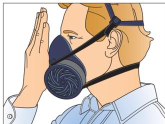
**Verificación de sello de presión positiva:** Cubra el venteo de la válvula de exhalación y exhale suavemente para crear una ligera presión positiva. Si detecta una fuga de aire, reajuste la posición de la máscara y la tensión de ambas correas para la cabeza y repita la verificación de sello hasta que se elimine la fuga.
