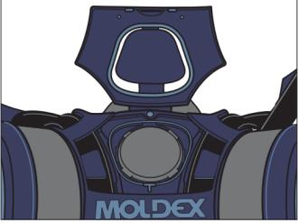
Para bloquear las correas en su posición, abra la cubierta de la válvula tirando del seguro. Coloque las correas por debajo de las lengüetas del canal de correas. Cierre a presión la cubierta de la válvula.
