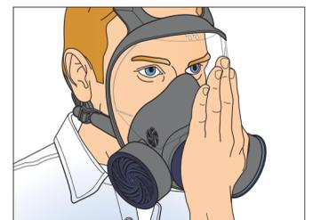
**Verificación de sello de presión positiva:** Cubra el venteo de la válvula de exhalación y exhale suavemente para crear una ligera presión positiva. Si detecta una fuga de aire, reajuste la posición de la máscara y la tensión de ambas correas para la cabeza y repita la verificación de sello hasta que se elimine la fuga.
