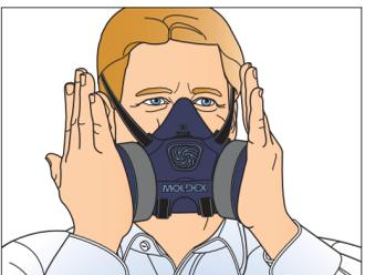
**Verificación de sello de presión negativa:** Cubra ambos cartuchos suavemente, inhale y contenga su aliento. La máscara debe hundirse ligeramente. Si detecta una fuga de aire, reajuste la posición de la máscara y la tensión de ambas correas para la cabeza y repita la verificación de sello hasta que se elimine la fuga.
