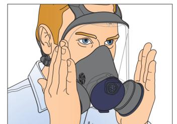
**Verificación de sello de presión negativa:** Cubra ambos cartuchos suavemente, inhale y contenga su aliento. La máscara debe hundirse ligeramente. Si detecta una fuga de aire, reajuste la posición de la máscara y la tensión de ambas correas para la cabeza y repita la verificación de sello hasta que se elimine la fuga.
