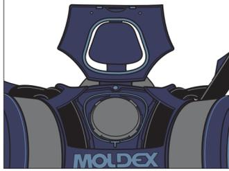
Abra la cubierta de la válvula tirando hacia arriba del seguro. Coloque las correas por arriba de las lengüetas del canal de correas. Cierre a presión la cubierta de la válvula.
